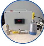
TSE露点节能控制(可选配置) TSE依据出口的干燥露点实行动态的控制，侦测到吸附周期中的干燥塔未达饱和时，将延长其切换的周期，在保证稳定露点同时更能最大程度节省再生所需的耗气量。可选配露点过高警报功能
